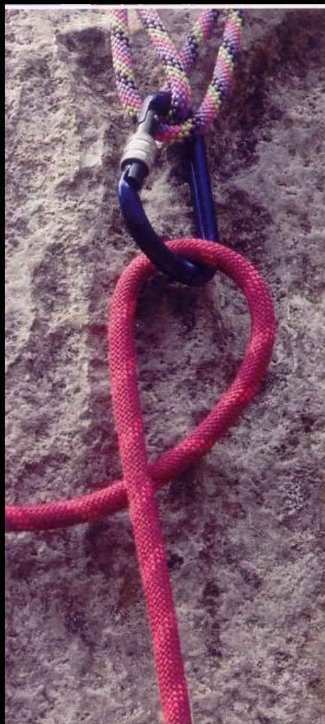
Nodo mezzo - barcaiolo, costruito direttamente nel moschettone e particolare importante: IN FASE DI CALATA (vedi corda in carico)
