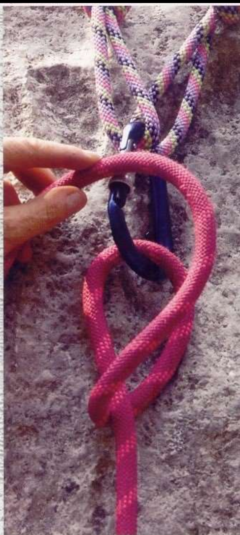
Nodo mezzo - barcaiolo, costruito direttamente nel moschettone e particolare importante: IN FASE DI CALATA (vedi corda in carico)
